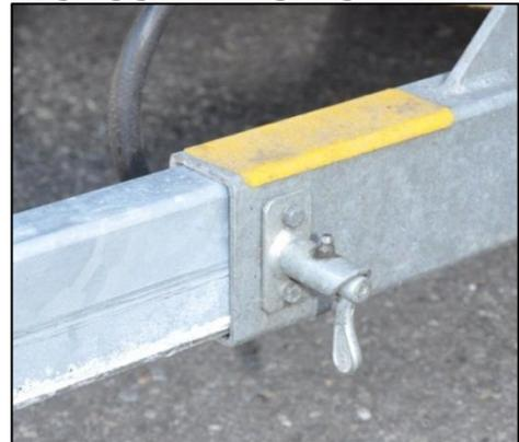
5. Stützen nach unten drehen und soweit senken, dass der Spalt bei den ineinandergeschobenen Rohren verschwindet.
