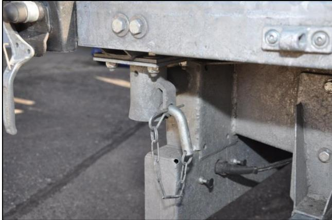
4. Rohre der Abstützungen hinten und vorne in Kipprichtung ausfahren und sichern. Falls die Kipprichtung gewechselt wurde, müssen die Rohre ganz entfernt werden und von der anderen Seite her eingeschoben werden. Wenn die Kippkabine an einer Wand platziert wird, müssen die Rohre vorgängig herausgezogen werden.
